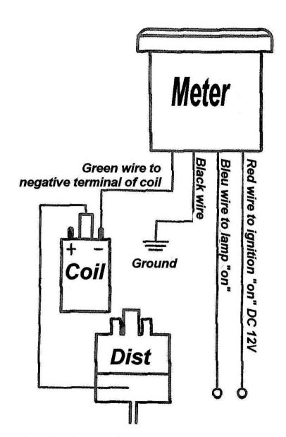
2 CYLINDERS 4 STROKES (1000rpm=16.6HZ)
